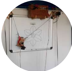
Robot traceur développé en sciences de l'ingénieur
